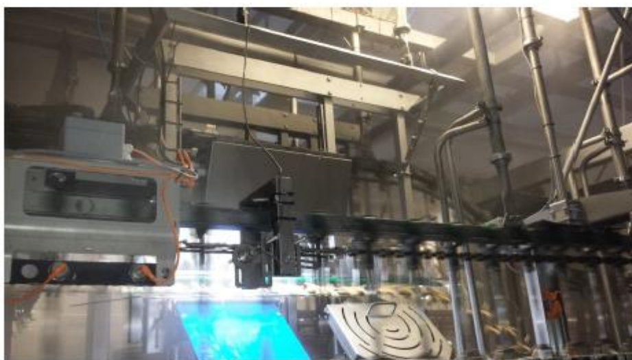
Figuur 21: camera set-up van het Meyn Footpad Inspection System in het slachthuis uit Van Harn & De Jong (2017).
