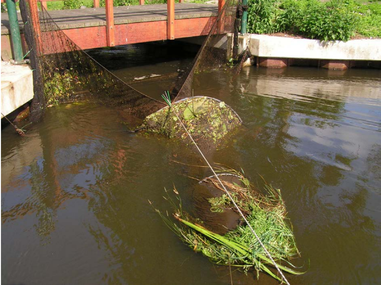
Foto 6: Staande fuik, in dit geval ten behoeve van een vistrapmonitoring. Vervuiling van netten, zoals op de foto, beïnvloedt de vangsteffectiviteit en dient zoveel mogelijk te worden voorkomen.
