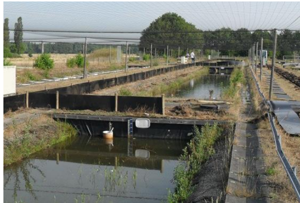
Figuur 6.2: Opstelling van gereguleerde sloten waarbij amfibieënschermen worden geplaatst tegen de ontsnapping van palingen en rivierkreeften (© Foto: Ivo Roessink) (Boerkamp et al. , 2012).
