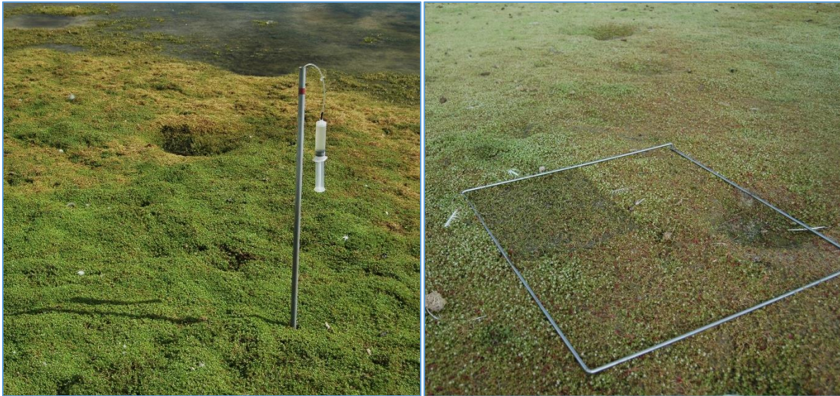
Figuur 2.2. Veldwerk waarbij (links) via een keramische cup bodemvocht met een spuit wordt opgezogen en (rechts) watercrassula wordt verzameld.
