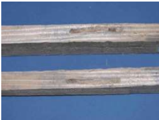
Verpakkingshout met boorgang van een Monochamus keverlarve en blauwverkleuring van het hout door schimmel. ©NVWA
